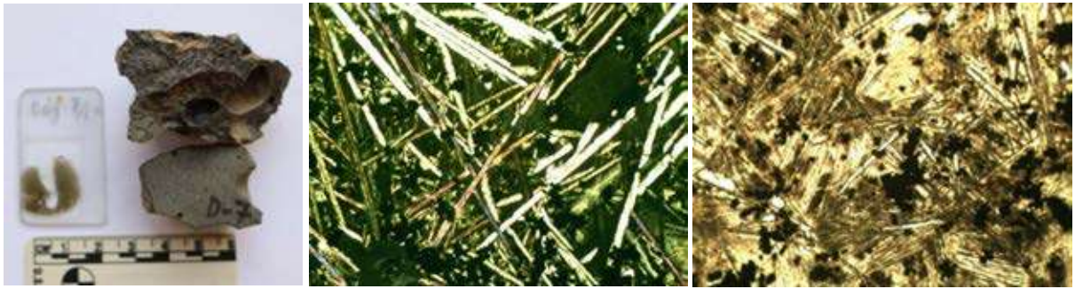
Fig. 54 s) Slag hand specimen # D7/19; photomicrographs: b).x100 xpl; c). x100 ppl.
